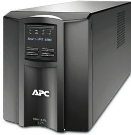
APC SMT1500IC. Topologia UPS: A linea interattiva, Potenza in uscita: 1500 VA, Potenza in uscita: 1000 W. Tipo di uscita AC: Accoppiatore C13, IEC Jumpers, Presa di corrente: Accoppiatore C14, Quantitc prese AC: 8 presa(e) AC. Tecnologia batteria: Acido piombo (VRLA), Durata della batteria (max): 5 anno/i, Tempo di ricarica: 3 h. Fattore di forma: Mini tower, Colore del prodotto: Nero, Lunghezza cavo: 1,83 m. Larghezza: 171 mm, Profonditc: 439 mm, Altezza: 219 mm
